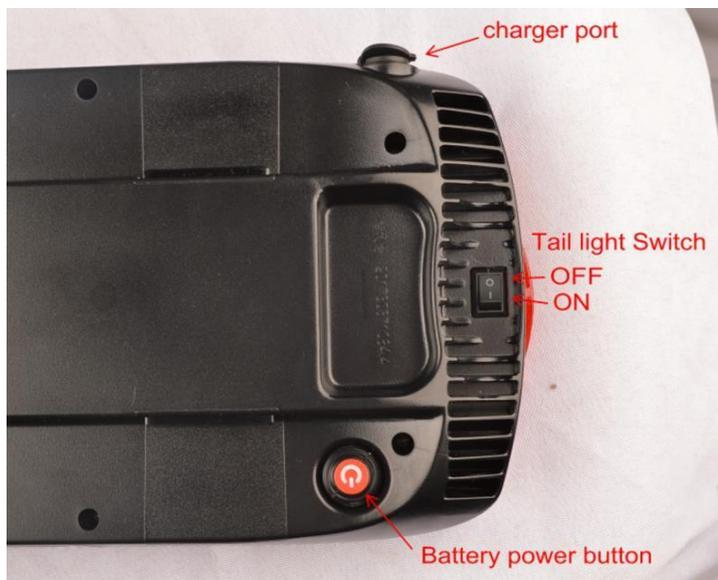
Si vous ne parvenez pas à mettre la clé en position « ON », il se peut que la pile ne soit pas correctement alignée. Utilisez votre paume pour appuyer physiquement sur la pile et assurez-vous qu'il n'y a pas d'espace entre la pile et le socle. Les quatre broches doivent se connecter complètement à la pile.
